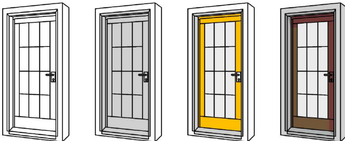
Figura 6 – Exemplo de diferentes aparências de uma porta: sem cor (A), uma só cor (B), cor do material (C), e texturas (D)
