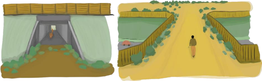
Passagem inferior e ponte adaptadas para a passagem da fauna
