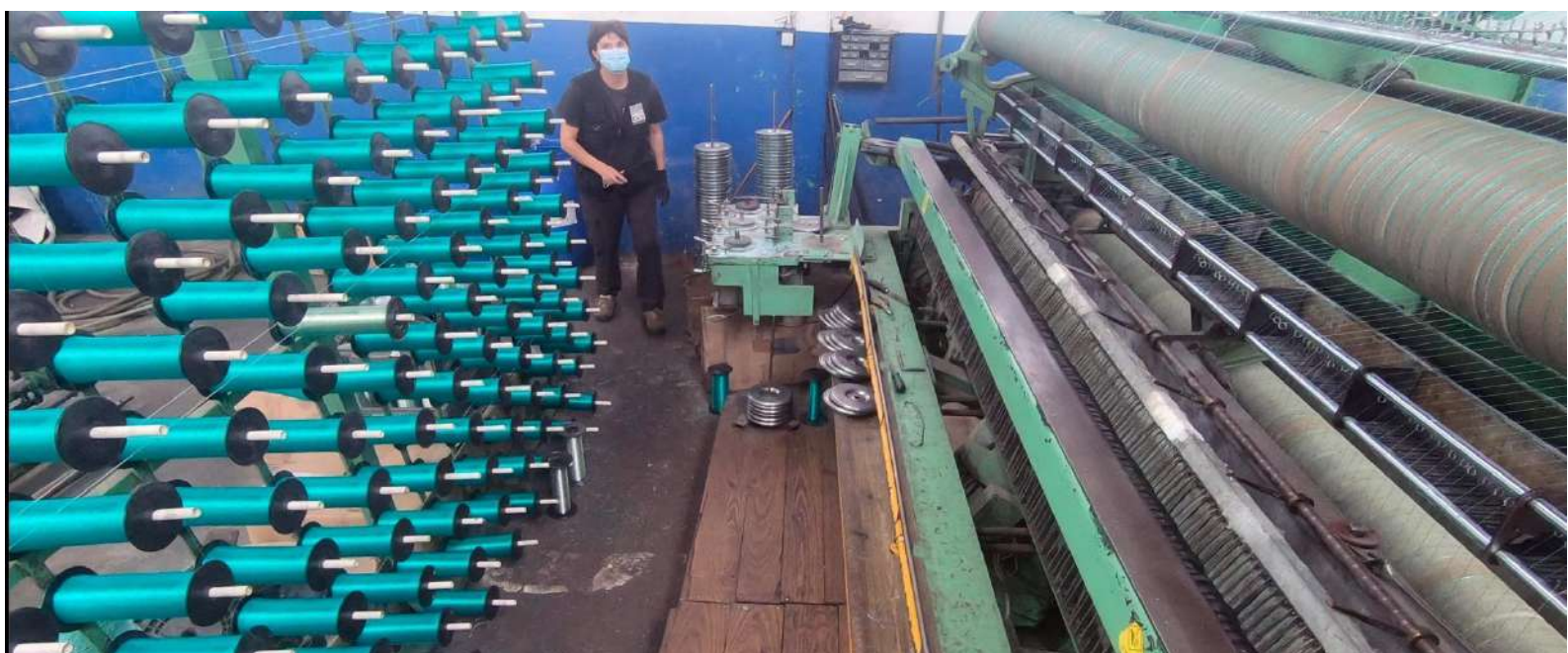
Figura 7. Fabrico de redes a partir de monofilamento biodegradável.
