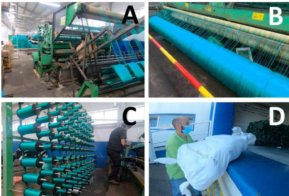
Figura 8. Fabrico de redes biodegradáveis. A) Vista geral da linha de produção; B) Vista detalhada do tear; C) bobines (RO800L) com 1 Kg de monofilamento no tear; D) Entrega de redes acabadas.
