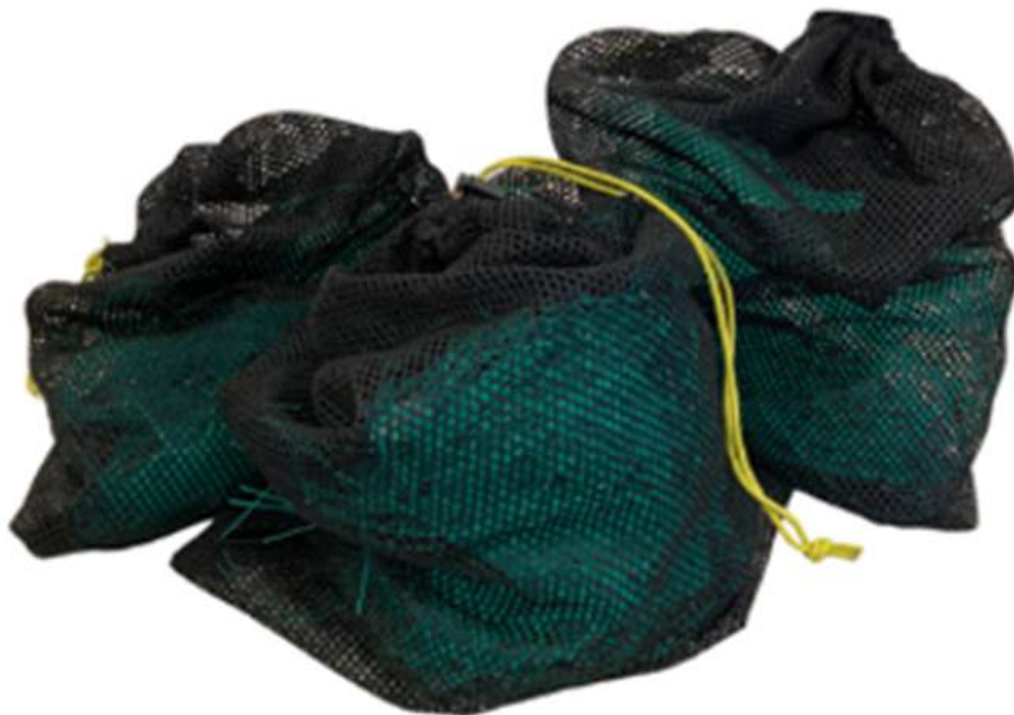
Figura 6. Amostras de redes convencionais e biodegradáveis preparadas para colocação em ambiente marinho.
