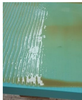
Figura 11. Cola na placa antes e depois de espalhada com a espátula de ranhuras.
